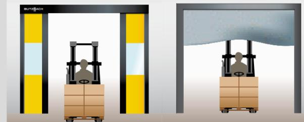
La sicurezza è sempre stata una priorità assoluta nello sviluppo della serie NOVOSPRINT. Le sezioni trasparenti ad altezza occhi consentono al conducente di vedere al di là anche quando il portone si sta aprendo.
